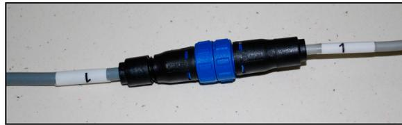
Abb. 7 Steckverbindung zur Tastatur
