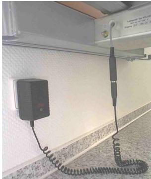
Batterieladegerät mit der Netzversorgung (230V ~ / 50 Hz Steckdose) verbinden.
