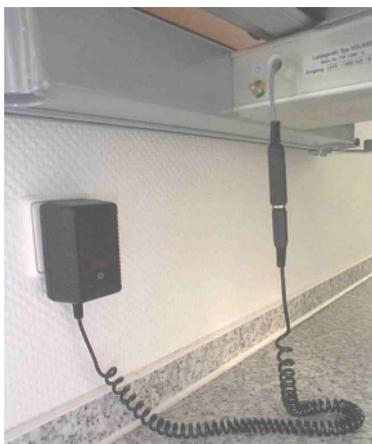
Batterieladegerät mit der Netzversorgung (230V ~ / 50 Hz Steckdose) verbinden.
