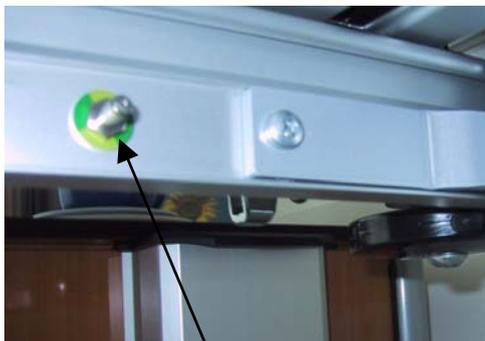
Der Anschlussbolzen für die Potentialausgleichsleitung befindet sich an der Wange, kopfseitig links.
