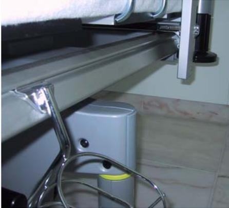
Die Halterungen für die verschiedenen Zubehörartikel können in die Seitenwangen eingehakt werden und das Zubehör kann so angebracht werden.
