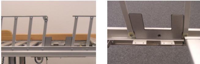
7. Setzen Sie die Seitengitterkappe (Pos. 06) auf das untere Ende der mitgelieferten Seitengitterstrebe (Pos. 10) und verschrauben (Pos. 4+5) diese mit dem Wangenprofil.
