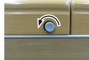
2. Entfernen Sie die Befestigungsschrauben von Handlauf und Seitengitterstreben mit einem 15er Torx-Biteinsatz und verlängertem Aufsatz.
