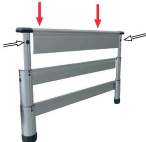
**⚠️ WARNUNG** Um die geforderte Mindesthöhe von 220 mm über der Matratzenoberkante zu gewährleisten, müssen die feststehend-geteilten Seitengitter auf die volle Höhe ausgezogen werden. Wird das Seitengitter nur bis zur mittleren Stellung ausgezogen, ist die Seitengitterschutzfunktion nicht gegeben!
