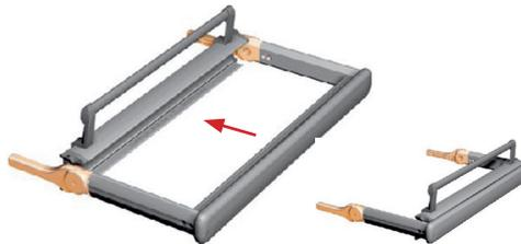
Die Seitengitterelemente können nach Bedarf ein- oder mehrfach eingesetzt werden, um den Patienten zu schützen.
