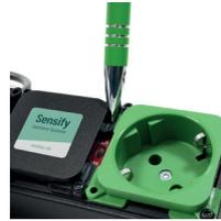
3. Die LRN- und CLR-Tasten liegen leider etwas schwer zugänglich. Zum Drücken der Tasten benötigen Sie einen Kugelschreiber oder eine aufgebogene Büroklammer. Nochmals: Sie können dort keine stromführenden Teile berühren!
