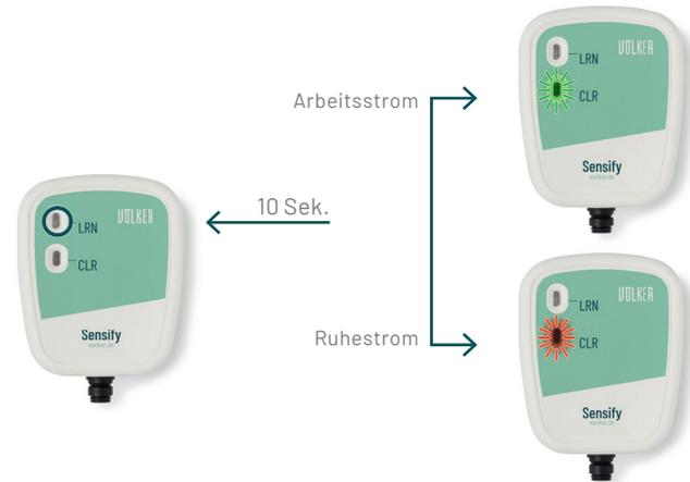
4. Drücken Sie die rote LRN-Taste ca. 10 Sek. dauerhaft, bis die Leuchte erlischt und die CLR-Taste grün (Arbeitsstrom) bzw. rot (Ruhestrom) blinkt.
