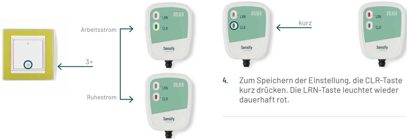
3. Drücken Sie jetzt 3× schnell hintereinander auf die 0 des Sensify Deaktivierungsschalters. Die CLR-Taste leuchtet kurzzeitig (2 Sek.), dauerhaft grün (Arbeitsstrom) oder rot (Ruhestrom). Das erneute Blinken signalisiert, dass der Schalter erkannt wurde.
