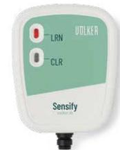
3. Drücken Sie 3 × kurz und schnell hintereinander auf einen Sensor. LRN-Taste leuchtet jetzt dauerhaft rot. Sensoren und Funk-Empfänger bilden jetzt eine Einheit. Die Verbindung wird durch ein akustisches Signal bestätigt.
