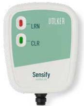
5. Die Anzeige auf dem Funk-Empfänger signalisiert die Einsatzbereitschaft mit LRN-Taste dauerhaft rot. Wird das Bett belegt, leuchtet die CLR-Taste zusätzlich grün und signalisiert optisch, dass das Bett belegt ist. Nach diesem Vorgang kann weiteres Zubehör, wie die automatische Lichtsteuerung oder der Notruf-Button, entsprechend der Bedienungsanleitungen angelernt werden. Verlässt der Bewohner das Bett, erfolgt sofort ein Signal auf die Schwesternrufanlage, das DECT-Telefon und Pager.
