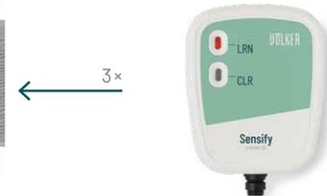
4. Drücken Sie 3× kurz und schnell hintereinander auf einen Sensor. LRN-Taste leuchtet jetzt dauerhaft rot. Sensoren und Funk-Empfänger bilden eine Einheit. Die Verbindung wird durch ein akustisches Signal bestätigt.
