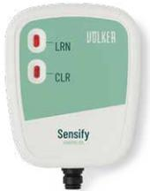
6. Die Anzeige auf dem Funk-Empfänger signalisiert die Einsatzbereitschaft mit LRN-Taste dauerhaft rot. Wird das Bett belegt, leuchtet die CLR-Taste rot und signalisiert optisch, dass das Bett belegt ist. Nach diesem Vorgang kann weiteres Zubehör, wie die automatische Lichtsteuerung oder der Notruf-Button, entsprechend der Bedienungsanleitungen angelernt werden. Verlässt der Bewohner das Bett, erfolgt sofort ein Signal auf die Schwesternrufanlage, das DECT-Telefon und Pager.
