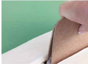
4. Die Einschubhilfen einzeln etwas zurückziehen und den Rest der Sensoreinheit komplett einschieben.
