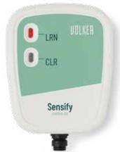
1. Durch ziehen und wieder einstecken des Funk-Empfängers kann dieser nur innerhalb der nächsten 30 Sek. programmiert werden. Die LRN-Taste leuchtet rot.
