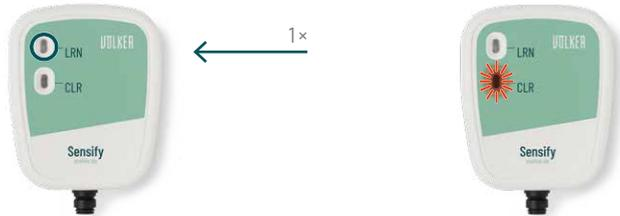
2. Drücken Sie einmal kurz auf die LRN-Taste. Der Funk-Empfänger wird dadurch in den Ruhestrom umgestellt. Die CLR-Taste blinkt rot.
