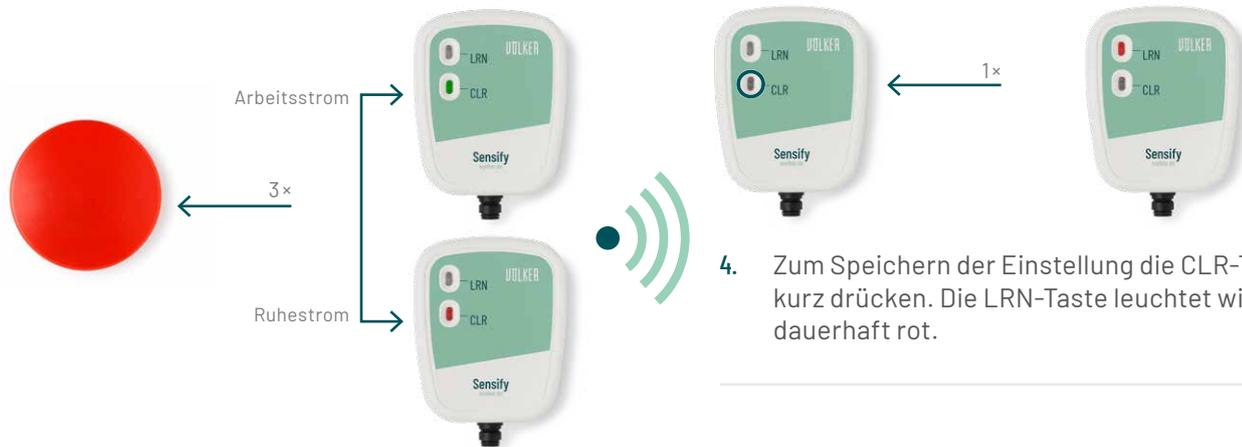
3. Drücken Sie jetzt 3× schnell hintereinander auf den Notruf-Button. Die CLR-Taste leuchtet kurzzeitig (ca. 2 Sek.), dauerhaft grün (Arbeitsstrom) oder rot (Ruhestrom). Das erneute Blinken und ein akustischer Ton signalisieren, dass der Notruf-Button erkannt wurde.
