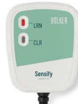
3. Verbinden Sie das Adapterkabel mit Ihrer Rufanlage. Die Anzeige auf dem Funk-Empfänger signalisiert die Einsatzbereitschaft mit LRN-Taste dauerhaft rot.
