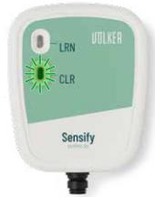
1. Das Adapterkabel muss in den Funk-Empfänger gesteckt werden. Stecken Sie dann den Funk-Empfänger in die Steckdose. Die CLR-Taste Anzeige blinkt grün (Anlernmodus).
