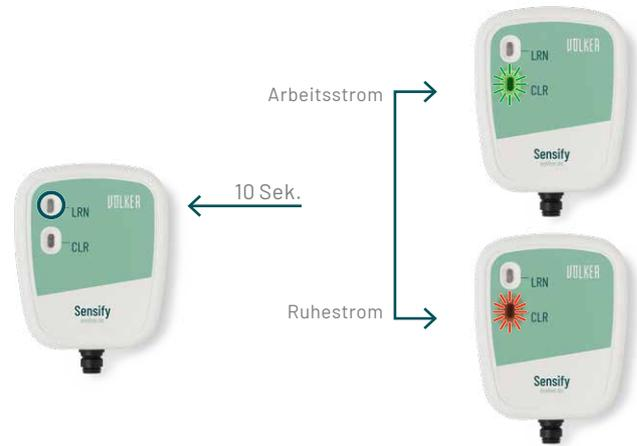
2. Drücken Sie die LRN-Taste ca. 10 Sek. bis die CLR-Taste grün blinkt (Arbeitsstrom) oder rot blinkt (Ruhestrom), je nachdem welches Rufanlagen-System Sie nutzen.
