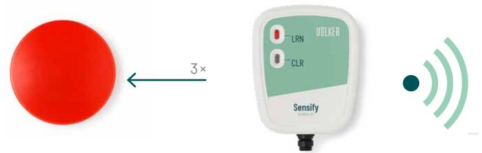
2. Drücken Sie kurz und schnell 3× hintereinander auf den Sensify Notruf-Button. LRN-Taste leuchtet jetzt dauerhaft rot. Notruf-Button und Funk-Empfänger bilden jetzt eine Einheit. Die Verbindung wird durch ein akustisches Signal bestätigt.
