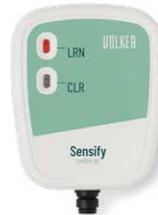
4. Verbinden Sie das Adapterkabel mit Ihrer Rufanlage. Die Anzeige auf dem Funk-Empfänger signalisiert die Einsatzbereitschaft mit LRN-Taste dauerhaft rot.
