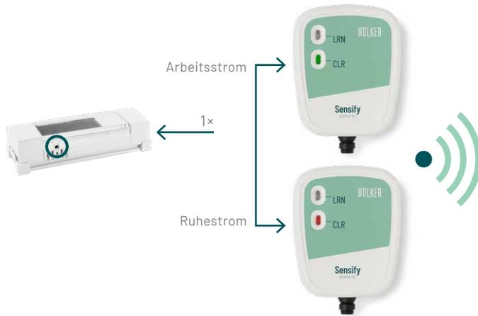
3. Drücken Sie jetzt 1× auf den Sensify Tür-Sensor. Die CLR-Taste leuchtet kurzzeitig (ca. 2 Sek.), dauerhaft grün (Arbeitsstrom) oder rot (Ruhestrom). Das erneute Blinken und ein akustischer Ton signalisieren, dass der Tür-Sensor erkannt wurde.
