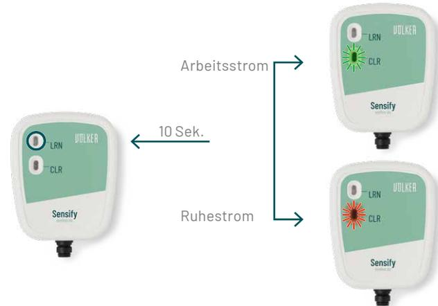
4. Drücken Sie die LRN-Taste ca. 10 Sek. bis die CLR-Taste grün blinkt (Arbeitsstrom) oder rot blinkt (Ruhestrom), je nachdem welches Rufanlagen-System Sie nutzen.
