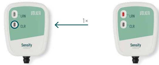
4. Zum Speichern der Einstellung die CLR-Taste kurz drücken. Die LRN-Taste leuchtet wieder dauerhaft rot.
