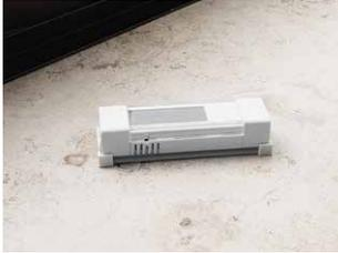
Der Sensify Tür-Sensor bezieht seine Stromversorgung umweltfreundlich aus den eingebauten Solarzellen. Vor der ersten Inbetriebnahme laden Sie den eingebauten Akku, indem Sie den Sensify Tür-Sensor für 15 Min. auf die Fensterbank oder unter eine Lampe legen.
