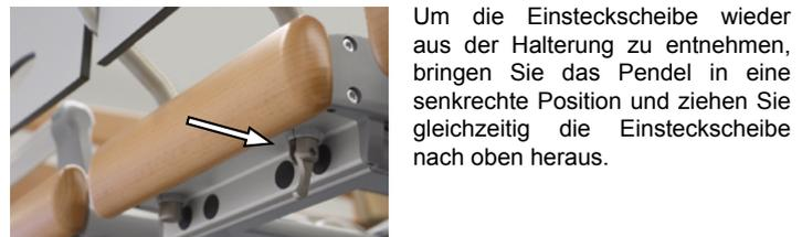
Um die Einsteckscheibe wieder aus der Halterung zu entnehmen, bringen Sie das Pendel in eine senkrechte Position und ziehen Sie gleichzeitig die Einsteckscheibe nach oben heraus.
