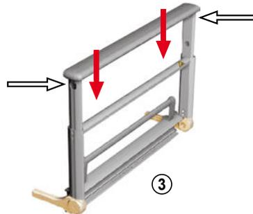
Betätigen Sie den mit „Drücken / Press“ beschrifteten Auslöser am unteren Ende des Seitengitters und kippen Sie es seitlich in die Horizontale, so dass es sich parallel zum Boden befindet. Schieben Sie das Seitengitter vollständig unter die Liegefläche (4).
