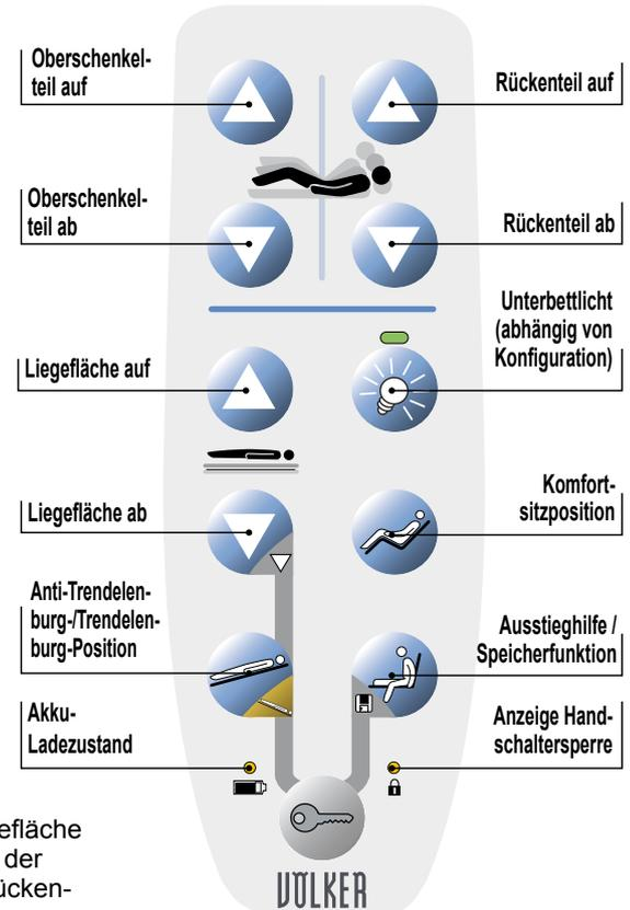
Eine horizontale Position der Liegefläche wird durch gleichzeitiges Drücken der Tasten „Oberschenkel ab“ und „Rückenteil ab“ erreicht.
