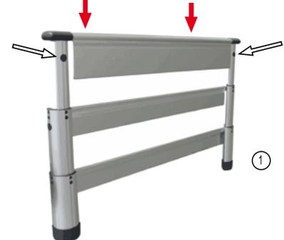
2. Zum weiteren Absenken heben Sie das Seitengitter an den Längsprofilen leicht an, um die unteren Auslösehebel zu entlasten. Dabei drücken Sie die beiden äußeren Verriegelungsknöpfe gleichzeitig ein und schieben den mittleren Teil nach unten in die niedrigste Position zurück.
